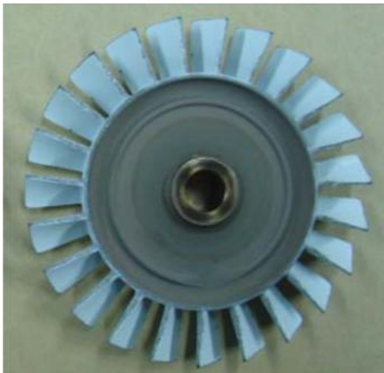
Kuva 6. TEOS:lla päällystetty mikrokaasuturbiinin aksiaaliturbiini. Altistusaikana 8 tuntia ja TEOS:n massaosuudella 2,3 % nestekaasun ja TEOS:n yhteismassasta. (Kim et al. 200, 131.)
