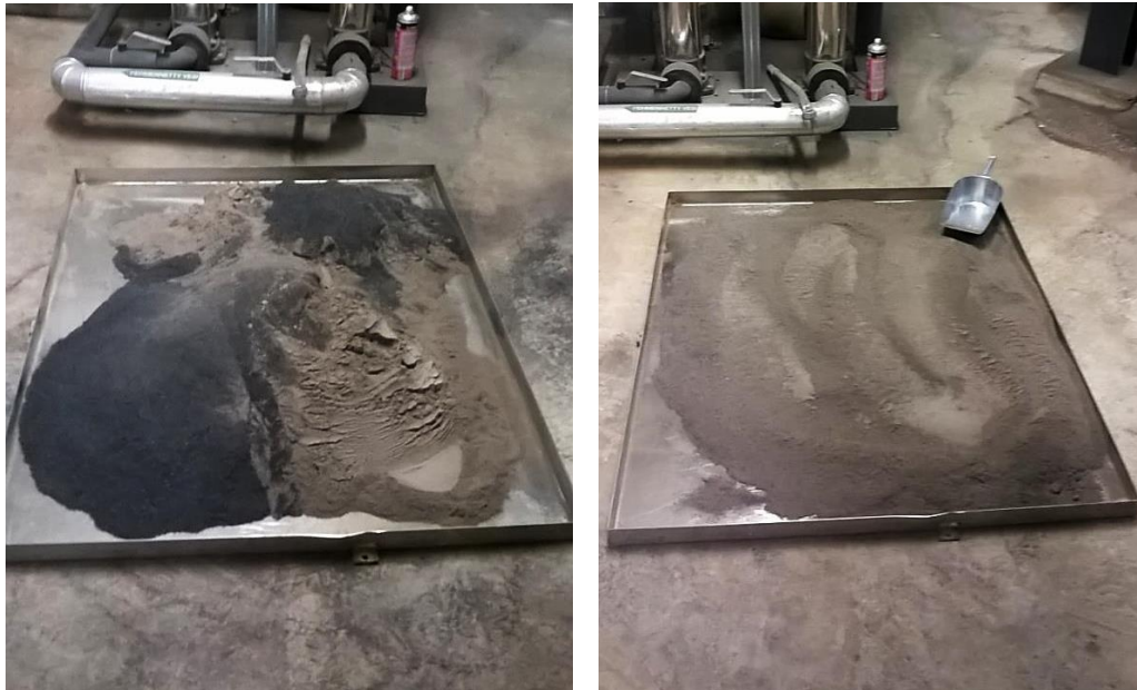
Kuva 3. Lentotuhkanäytteet yhdistettiin ja sekoitettiin tasalaatuiseksi yhdistetyksi tuhkanäytteeksi. Vasemmalla kuva ennen sekoittamista ja oikealla kuva sekoittamisen jälkeen. Oikealla näkyy myös standardin SFS-EN 932-1 mukainen näytteenottokauha, jolla sekoitetusta tuhkasta otettiin kokoomanäyte. Kokoomanäytteeseen otettiin useita kauhallisia tuhkaa eri puolilta, eri korkeuksilta ja eri syvyyksiltä tuhkakasasta, kuten standardissa SFS 932-1 mainitaan.
