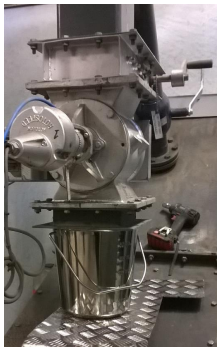
Kuva 1. Vasemmalla mittauspiste 1, jossa näytteenottoastia on asetettu konvektiotulistimelta putoavan tuhkavirran alle. Oikealla mittauspiste 2, jossa näytteenottoastia on asetettu ilmanesilämmittimeltä putoavan tuhkavirran alle. Normaalitylanteessa nämä tuhkavirrat tippuvat samalle kolakuljettimelle, jota pitkin
