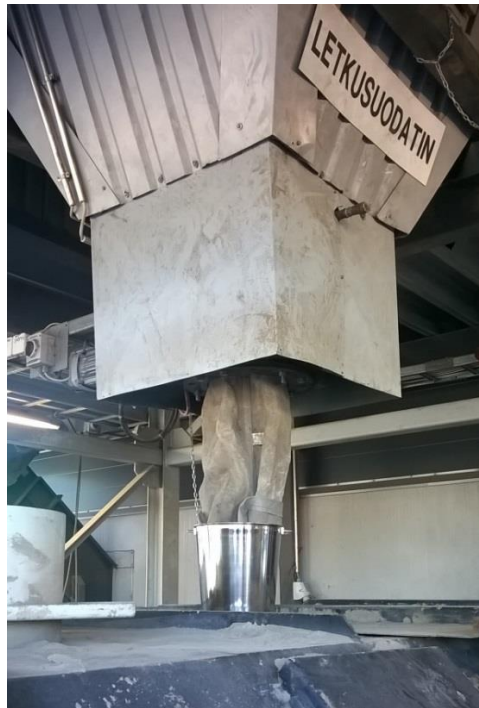
Kuva 2. Vasemmalla mittauspiste 3. Ämpäri asetettiin lentotuhkalavalle letkusuodattimelta tippuvaan virtaan. Tuhkaa tuli runsaasti, joten näytteitä otettiin useita osanäytteitä, joista kuva oikealla.
