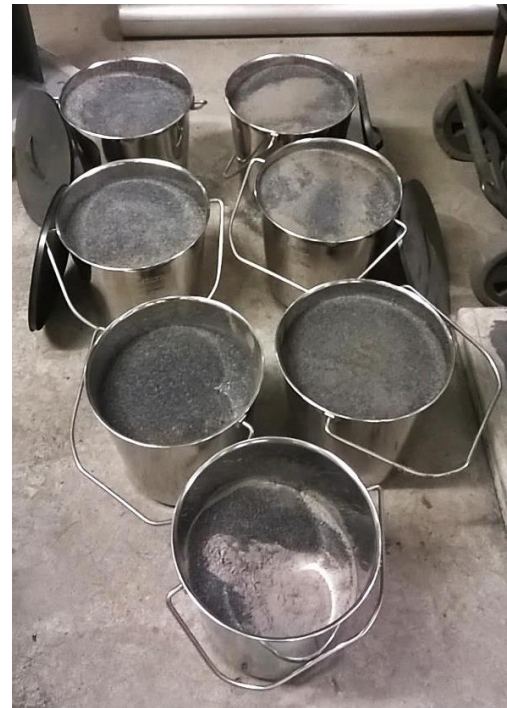
Kuva 2. Vasemmalla mittauspiste 3. Ämpäri asetettiin lentotuhkalavalle letkusuodattimelta tippuvaan virtaan. Tuhkaa tuli runsaasti, joten näytteitä otettiin useita osanäytteitä, joista kuva oikealla.
