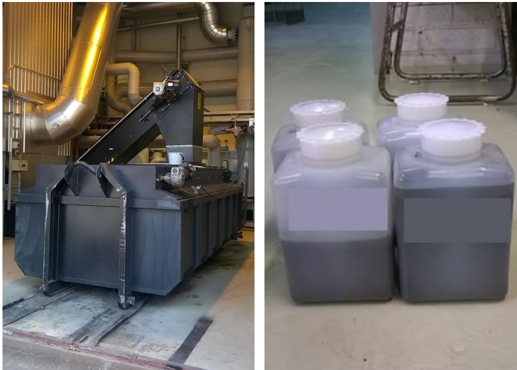
Kuva 6. Vasemmalla mittauspiste 1, jossa pohjatuhkanäyte otettiin kuljettimelta tippuvasta tuhkasta. Pohjatuhka tippui kattilasta ensin sammutuskaukaloon, joten tuhka oli märkää. Tämän takia se oli pakattava ja lähetettävä analysoitavaksi näytteenottopulloissa, joista kuva oikealla.
