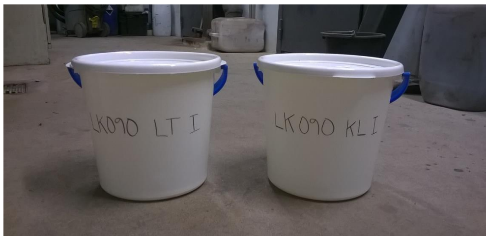
Kuva 4. Näytteiden annettiin jäähtyä, minkä jälkeen ne siirrettiin muoviämpäreihin, jotka lähetettiin laboratorioon. Kuvassa on valmiit kokoomanäytteet ensimmäisen päivän tuhkakokeesta.
