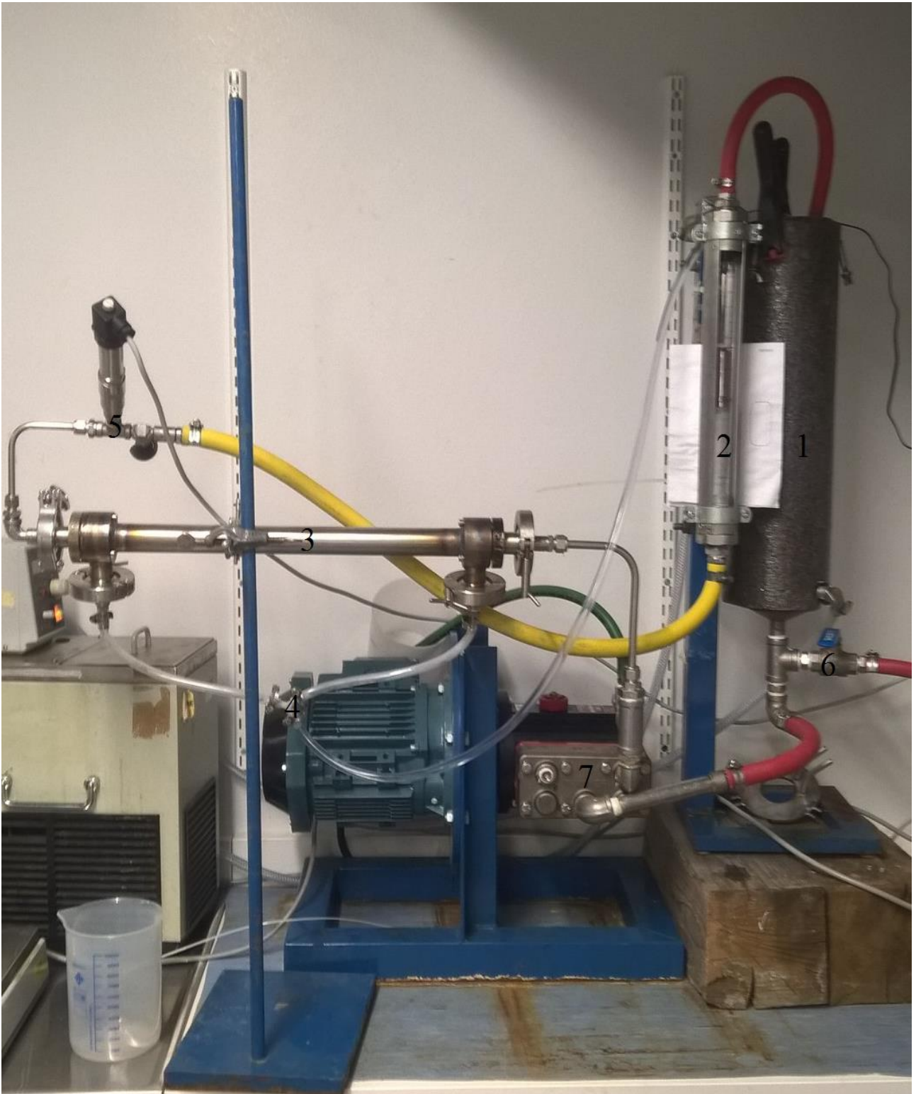
Kuva 6 Mittauksissa käytetty nanosuodatuslaitteisto keraamiselle membraanille.
