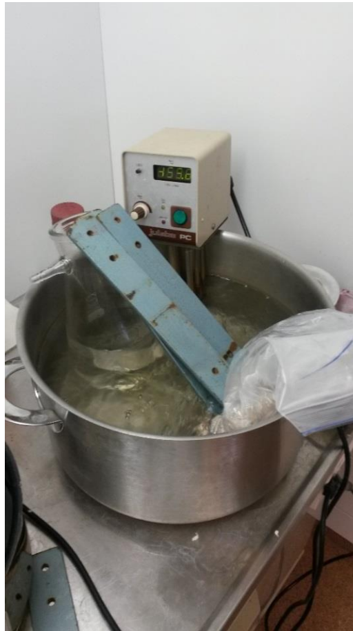
Kuva 2 Pussivalkaisumenetelmässä pussi pidettiin veden pinnan alapuolella metallilevyjen avulla.
