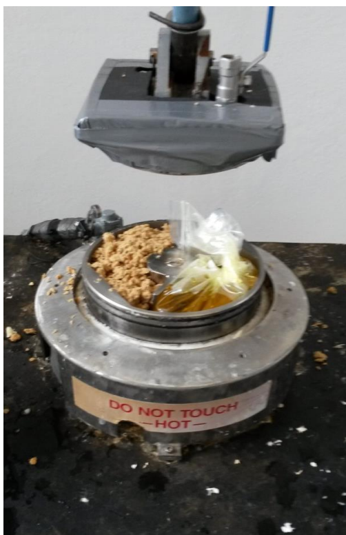
Kuva 4 Mark IV -reaktorin astia, johon on asetettu valkaisuainemäärä ja kemikaalipussi.
