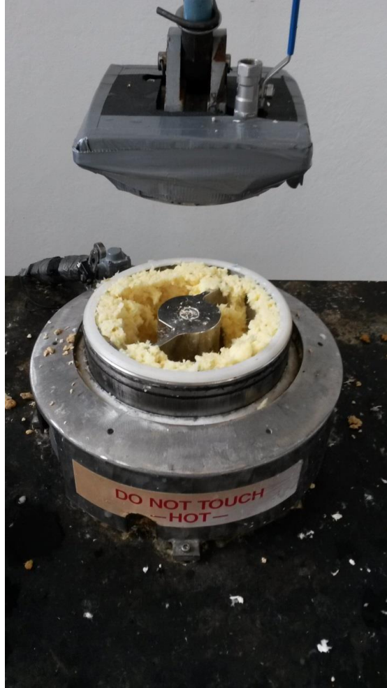
Kuva 3 Mark IV -reaktorin keskellä on sekoittaja, joka pyörii säädetyllä taajuudella sekoituksen ajan.
