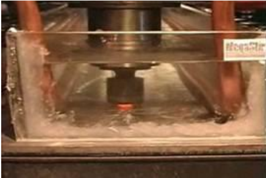
Kuva 8. Veden alla suoritettava kitkahitsaus pyörivällä työkalulla (Clark, 2004).
