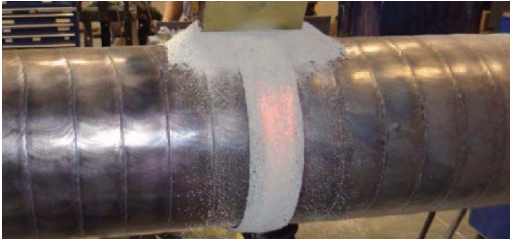
Kuva 2. Jauhekaarinauhahitsattava valssi (SMS Siemag, 2014, s. 5).
