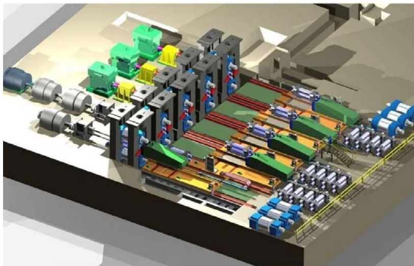
Kuva 6. Valssauslinjan vierelle järjestetty laitteisto, jolla helpotetaan valssien vaihtoa (CMI, 2012).
