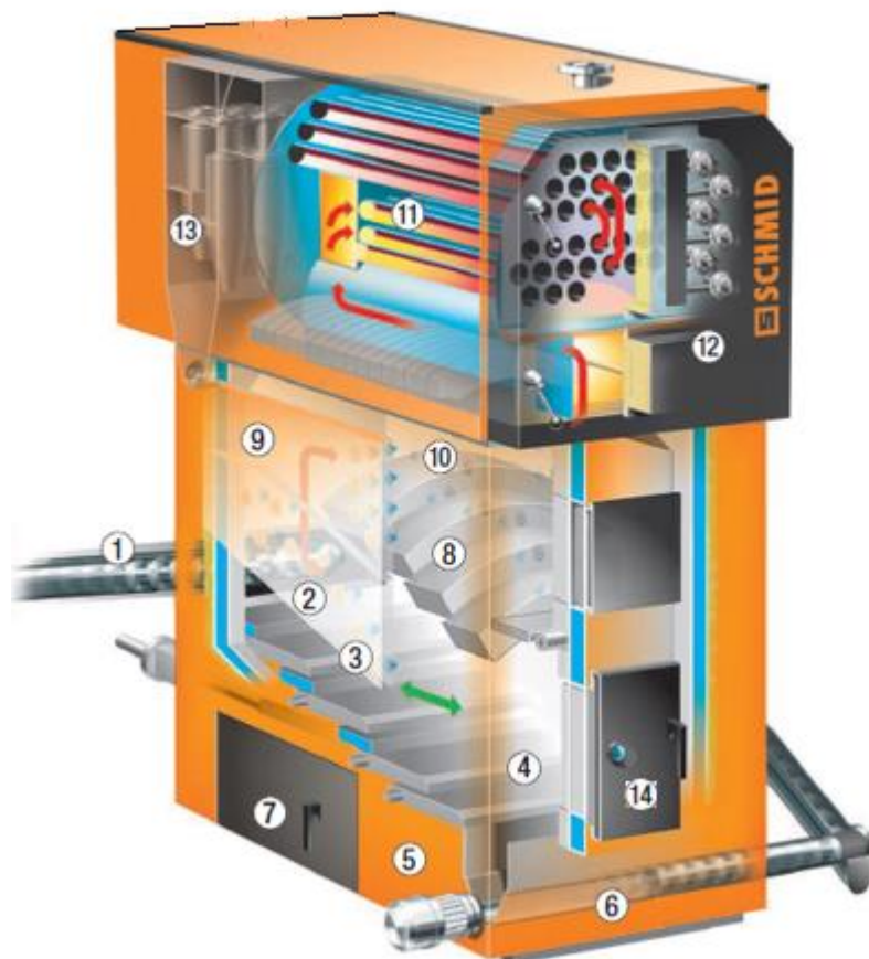
Kuva 12. UTSW 3200 -kattilan läpileikkaus. Muokattu lähteestä (Schmid AG).
