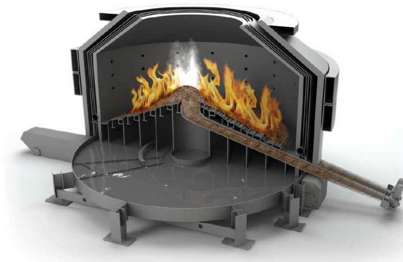
Kuva 10. Unicon Biograte -kattilan tulipesän läpileikkaus (KPA Unicon Oy 2015).
