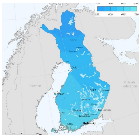
Kuva 4.4 Vuotuinen auringon säteily määrä [ \text{kWh}/\text{m}^2 ] ja 1 kW nimellistehoisen aurinkosähköjärjestelmän tuottama energian määrä [ \text{kWh}/\text{kW}_p ] 75 % kokonaishyötysuhteella vaakasuoralle pinnalle Suomessa. (PVGIS 2015)
