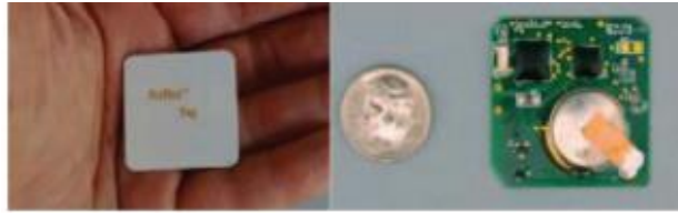
Kuva 8. RuBee-tag-tunnisteiden havainnollistava kuva, josta näkee myös tunnisteiden kokoluokan (Chen et al., 2011, s. 368).
