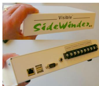
Kuva 9. The Sidewinder RuBee-reititin Visible Assets Inc yhtiöltä (RuBee, 2016b).
