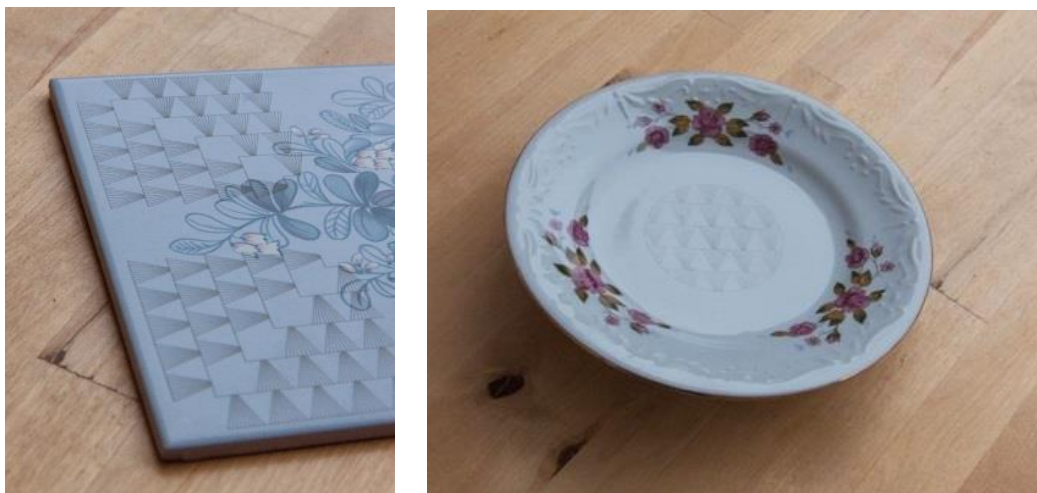
Kuva 5. a) Lasermerkattu keraamilaatta ja b) lasermerkattu posliinilautanen.
