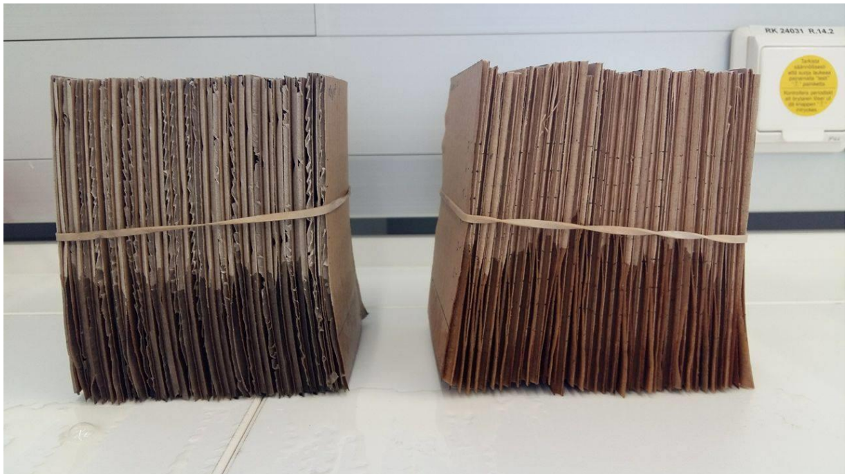
Kuva 12 160 g/m 2 - (vas.) ja elintarvikeaaltopahvi (oik.) kuutiokokeen jälkeen.
