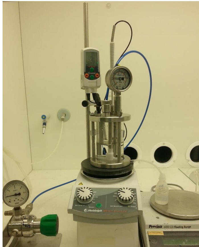
Kuva 8 Membranien puhdasvesivuon ja pidätyskyvyn mittauksiin käytetty Amicon-suodatinkenko.
