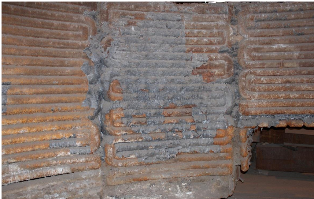
Kuva 14. Valokaariuunin jäähdytyspaneelit. Harmaa-alue on jähmettynyttä kuonaa.
