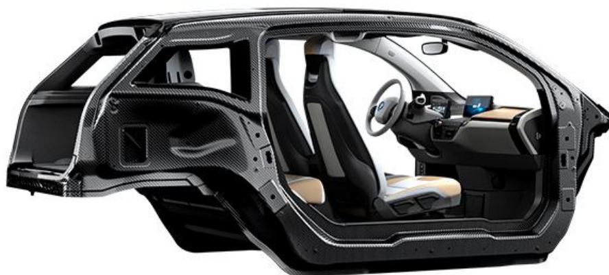
Kuva 1. BMW i3-mallin hiilikuidusta valmistettu runko (BMW 2015).
