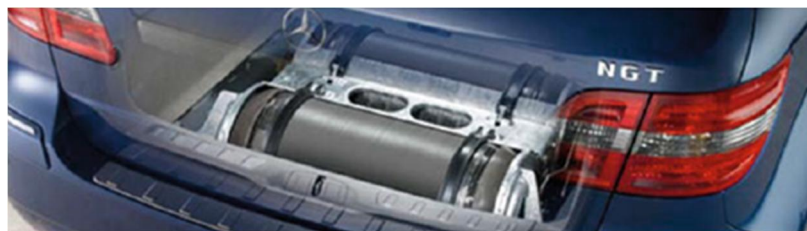
Kuva 4. Hiilikuidusta valmistettu kaasusäiliö ja sen sijoitus autossa (Park 2015, s. 260).
