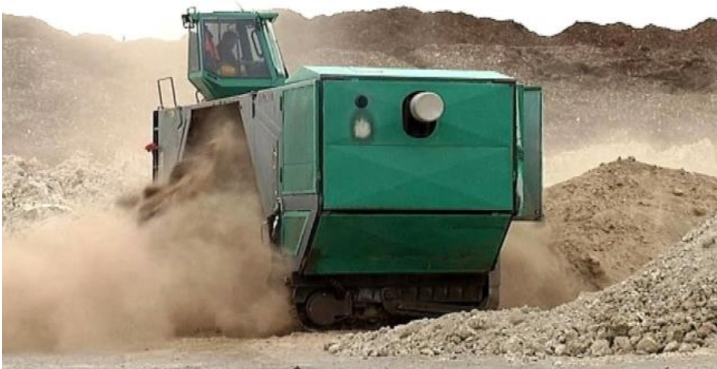
Kuva 28 . Soodasakan ja tuhkan sekoittaminen aumasekoittimella. (Mäntymaa, 2013)
