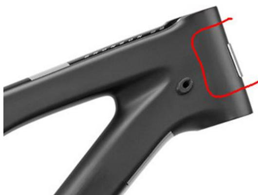
Kuva 17. Emäputken ohennettu kohta (muokattu Weber 2015).
