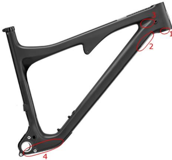
Kuva 14. Suurimmat jännityskeskittymät kuormitettaessa etuhaarukan alaosa sivulle päin. muokattu (Weber 2015).
