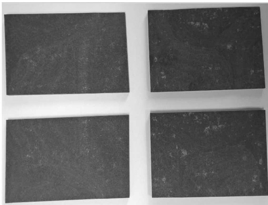
Kuva 38 Vasemmalla puolella tavallisella Absorbex®-paperilla ajetusta runkoimpregnaatista tehdystä laboriolaminaatista tehty halkaisunäyte, oikealla puolella lisämässä 1 sisältävällä koeajopaperilla tehdystä laboriolaminaatista tehty halkaisunäyte. Valkoiset alueet halkaisunäytteissä ovat imeytymättömiä kohtia.
