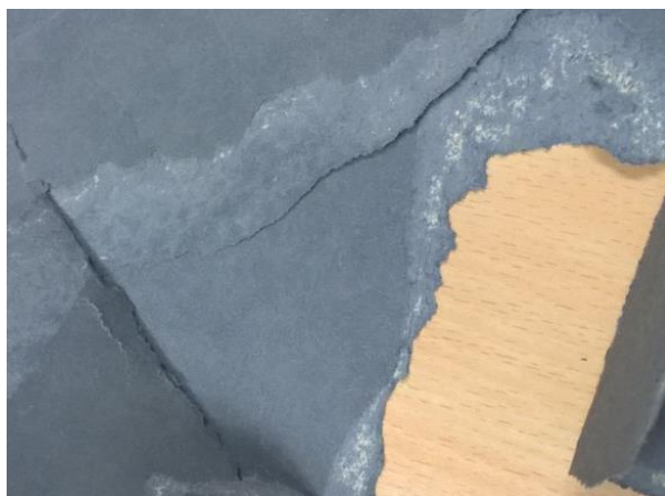
Kuva 37 Muutos impregnaatin imeytymässä. Ylempi impregnaatti tavallisella runkopaperilla ajettuna, alempi samoilla ajoarvoilla impregnointikoneella ajettuna runkopaperilla, jossa oli 10 % lisämässä 1:stä.
