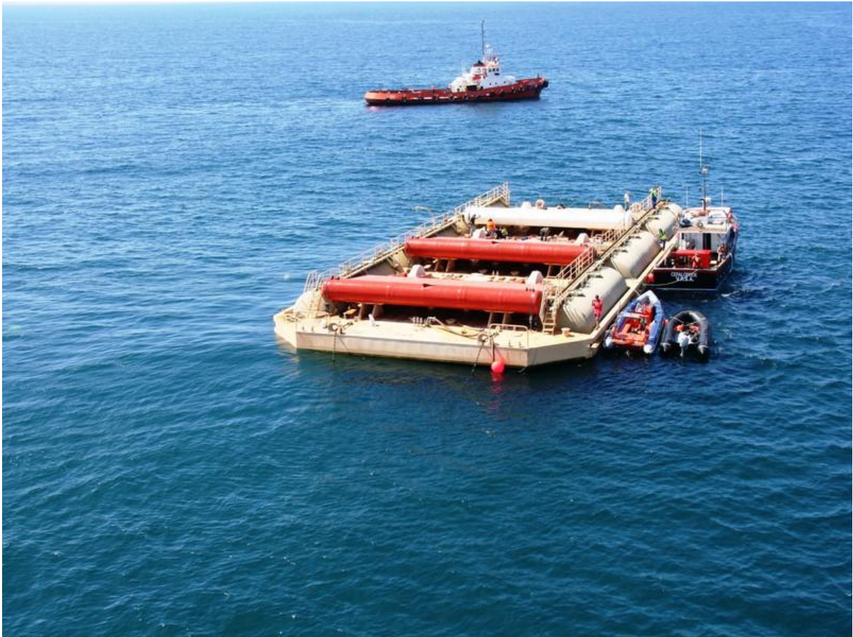
Kuva 8. WaveRoller-alusta, johon kuuluu kolme levyä. (Kuva: AW-Energy)
