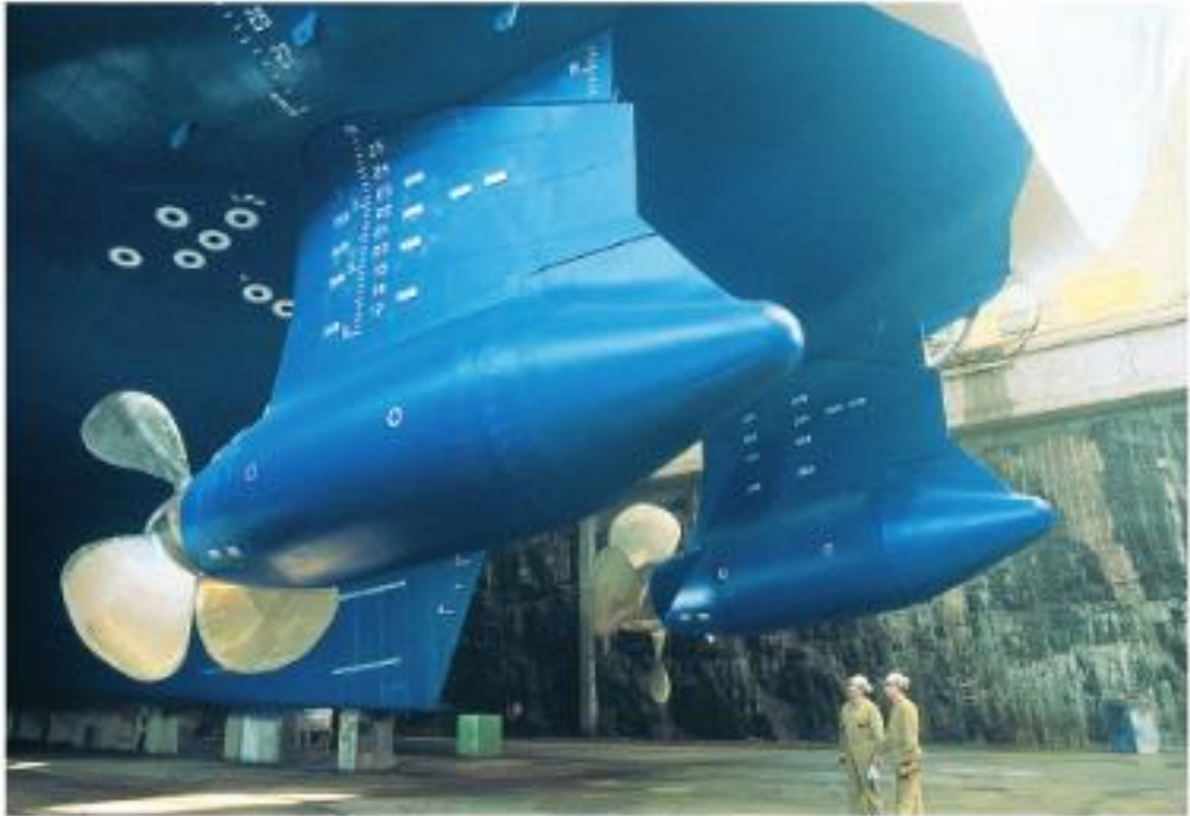
Kuva 1. ABB:n Azipod ruoripotkurit asennettuna risteilijään. (Energiatehokasta merimatkaa 2016)
