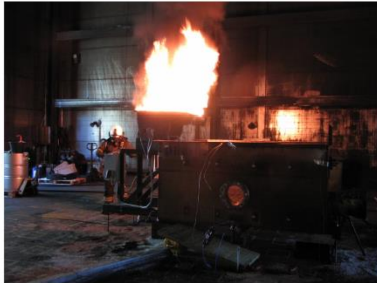
Kuva 4. Koevaihe. Öljyn esilämmityksen jälkeen se sytytettiin. Esipalooaika oli 2 minuuttia.
