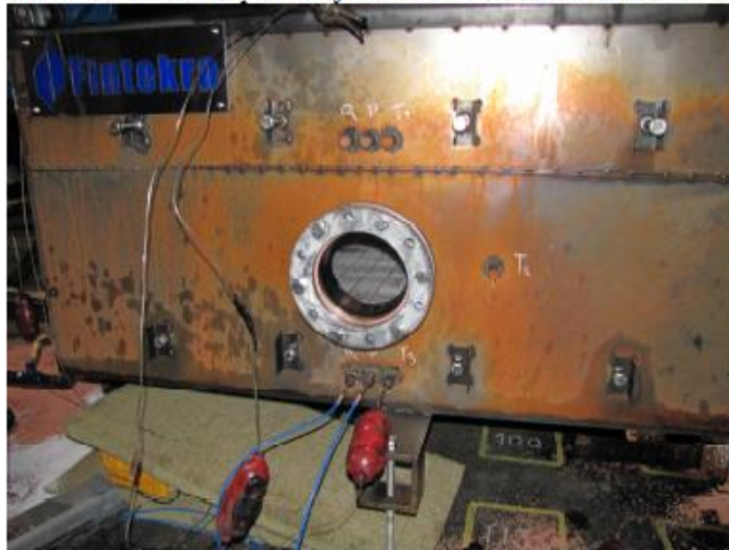
Kuva 2 Liekkiloukku - palonsuojarakenne asennettuna altaan ala-osaan
