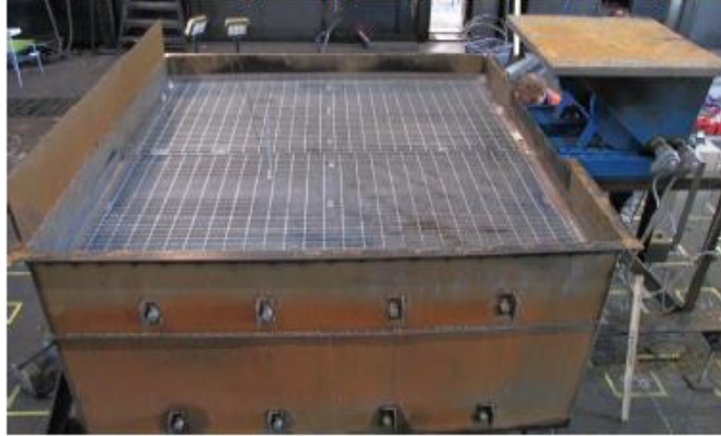
Kuva 2 Liekkiloukku - palonsuojarakenne asennettuna altaan ala-osaan
