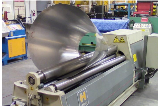
Kuva 20. Ohutlevykartion valmistusta (Dynamic Fabrication Inc 2017).
