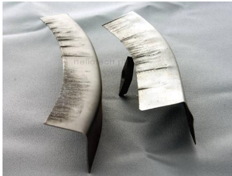
Kuva 19. Kutistamalla taivutettuja ohutlevyosia (Heliotech 2012).
