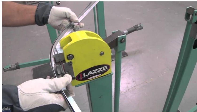
Kuva 18. Ohutlevylisten kutistaminen (Lazzemetalshaping 2010).
