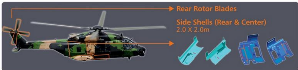
Kuva 10. NH-90 helikopterin komposiittiosat (Airbus 2015).
