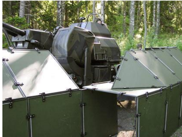
Kuva 7. RASS-monisuojajärjestelmä strategisesti tärkeän kohteen suojauksessa (FY-Composites b).
