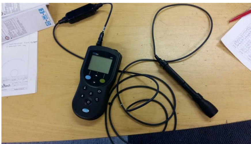
Kuva 2. HQ40D happimittari ja sen anturi.
