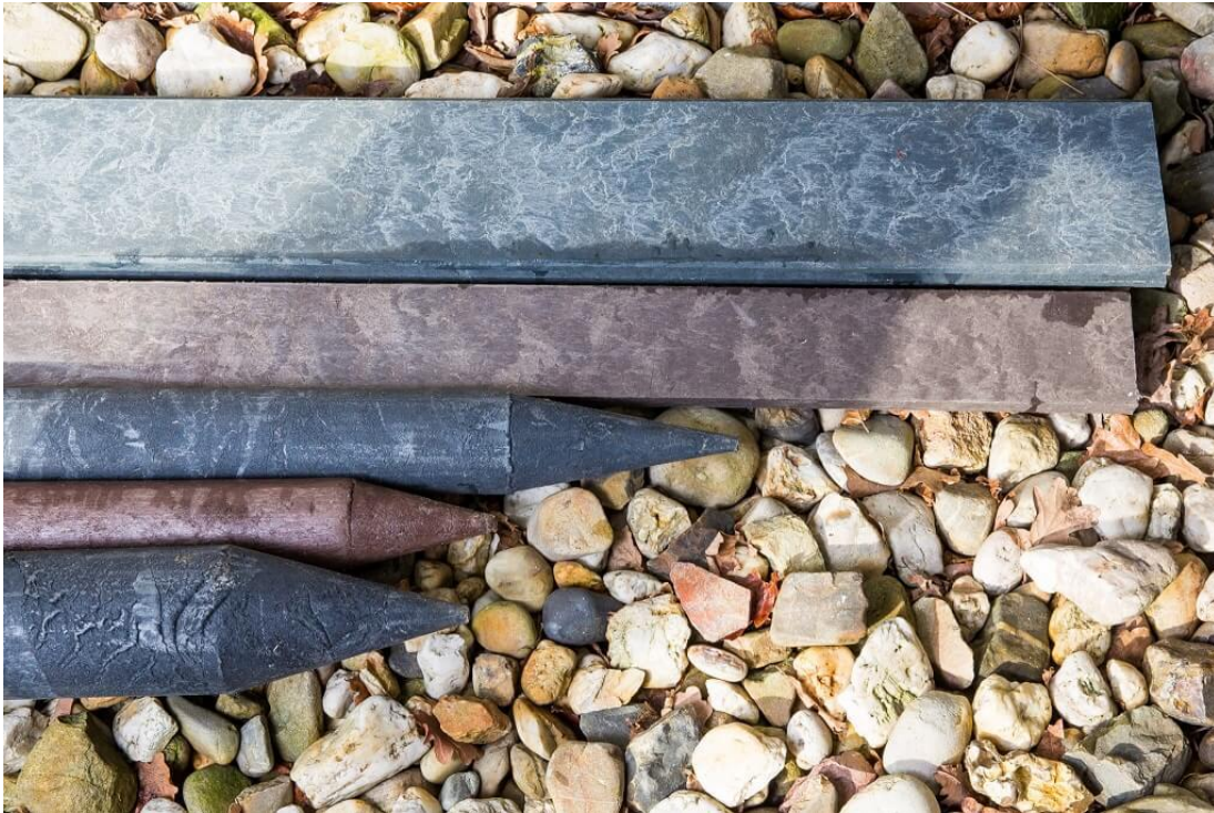
Kuva 4. Tekstiili- ja muovijätteestä valmistettuja komposiittitolppia. Lähde: Dutch Awareness, ( http://dutchawareness.com/circularworkwear/cliff/ )
