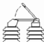
Kuva 5-4 Veitsierotin ja sen toimintaperiaate. (Kuosa 2007)
