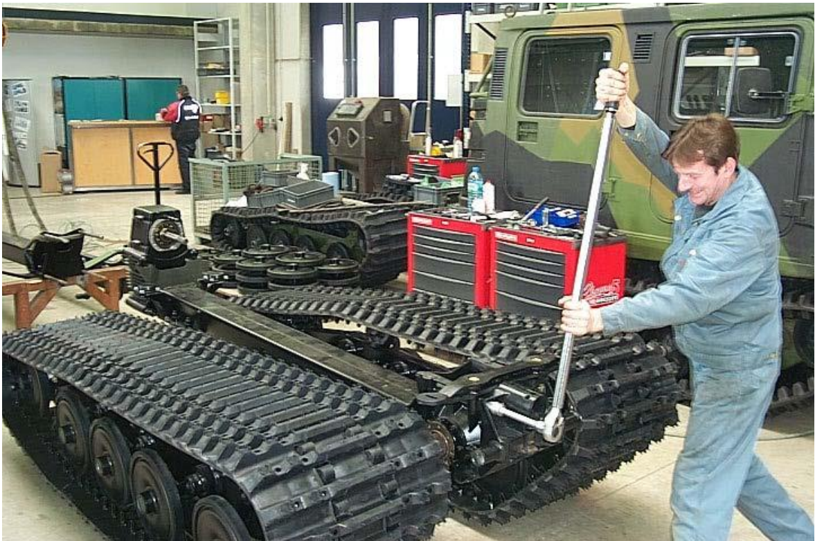
Kuva 17 Runkopalkki ratkaisu tela-ajoneuvossa (MILMAC. 2018)
