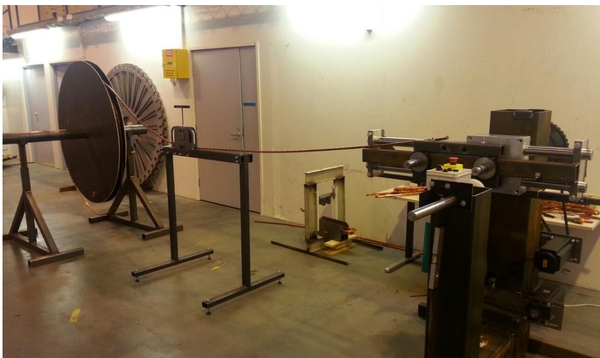
Kuva 5.1 Oikealla rakennettu kääminvalmistuslaite, vasemmalla kaapelinsyöttökela sekä mankeli.
