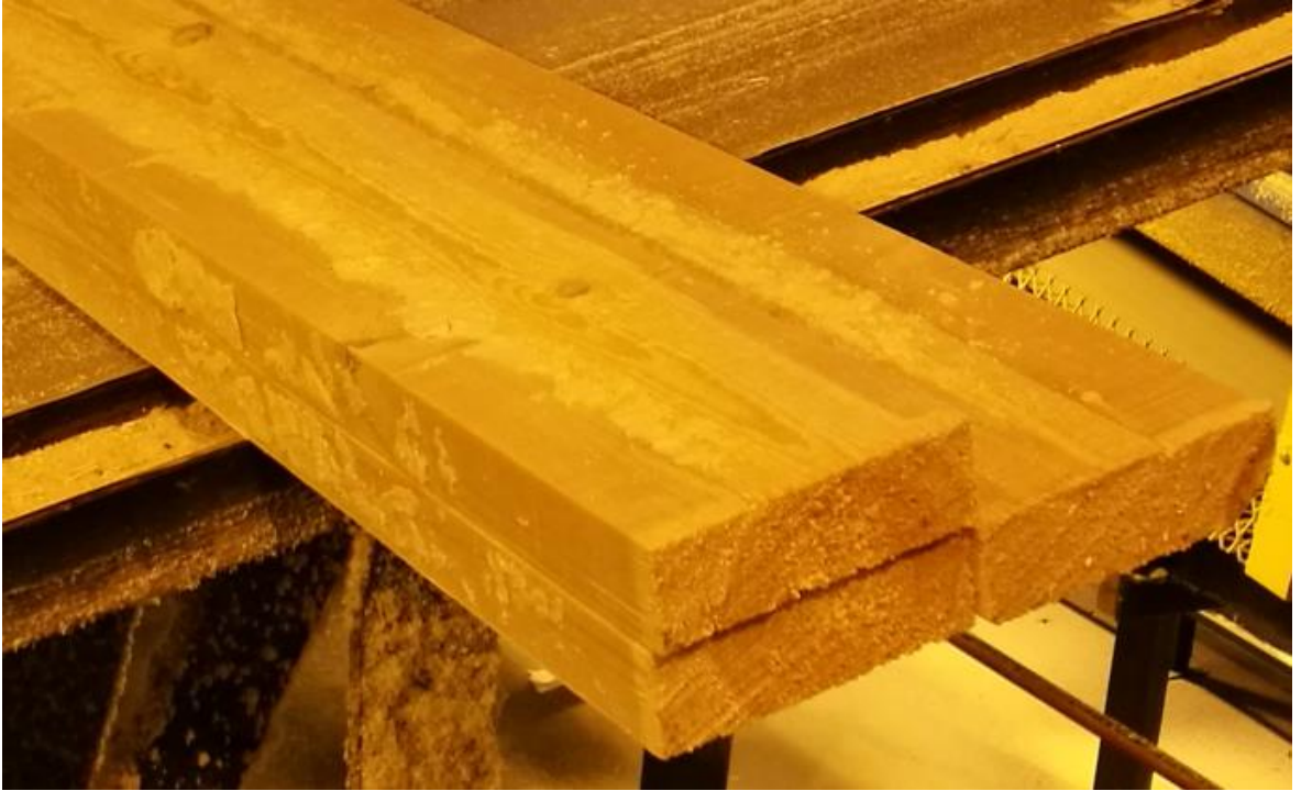
Kuva 7. Purun jääminen kiinni sahauspinnoille on vähäistä 0 °C lämpötilassa.
