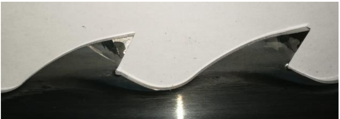
Kuva 3. Variaatio SB-, eli Kanadan teräogeometriasta. Kuvan terässä pohjatyssä estämässä purun ohivuotoa.
