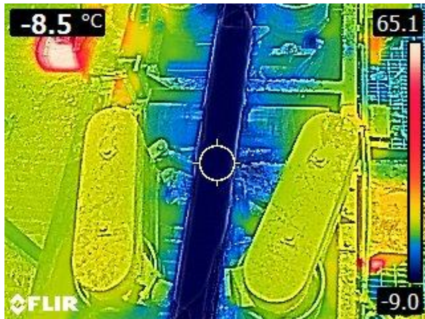
Kuva 9. Puun lämpötila ennen vannesahausta. Mitattu aiemmin pelkkahakkurilla haketetulta pinnalta, ei puun ulkopinnasta. Lämpötilalukema kuvan vasemmassa yläreunassa.
