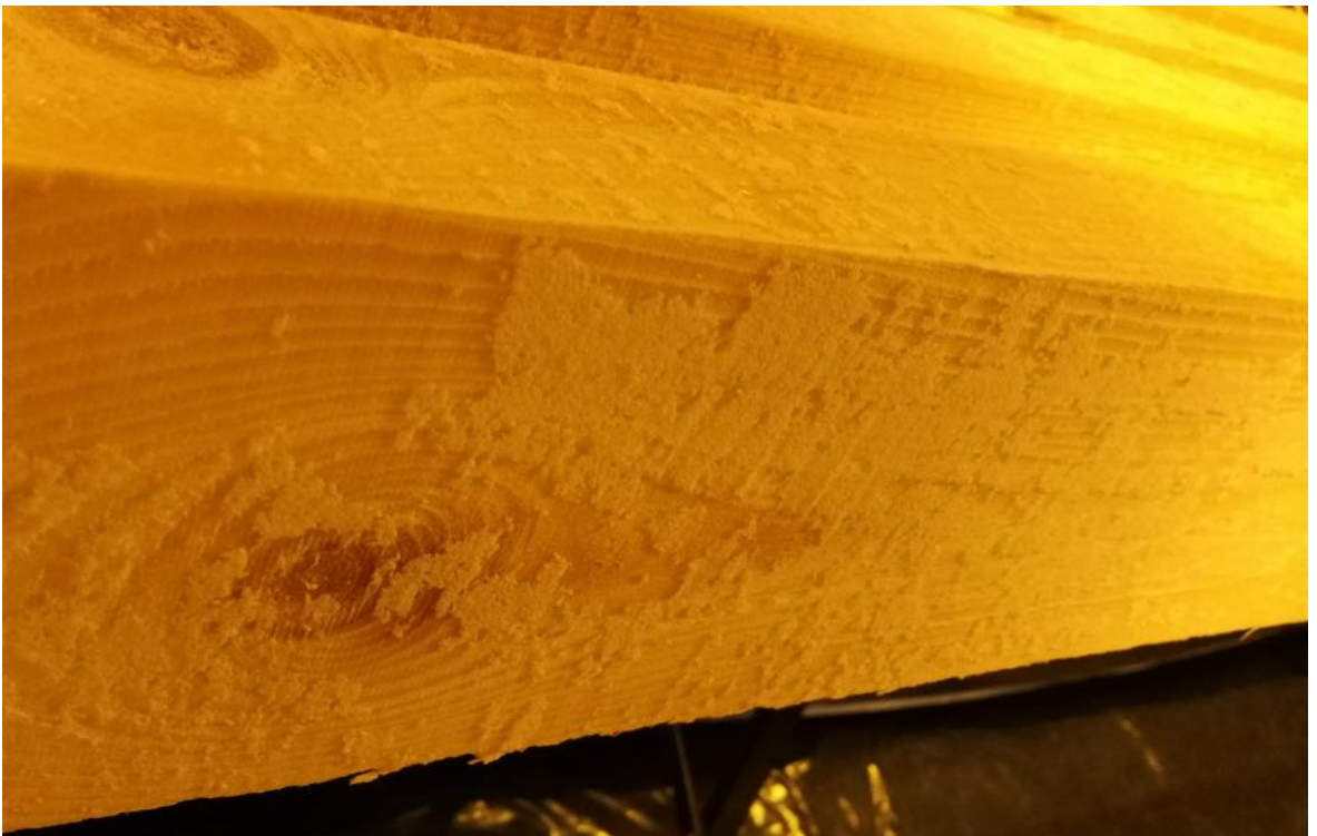
Kuva 8. Purua jää enempi kiinni jo -10 °C lämpötilassa.
