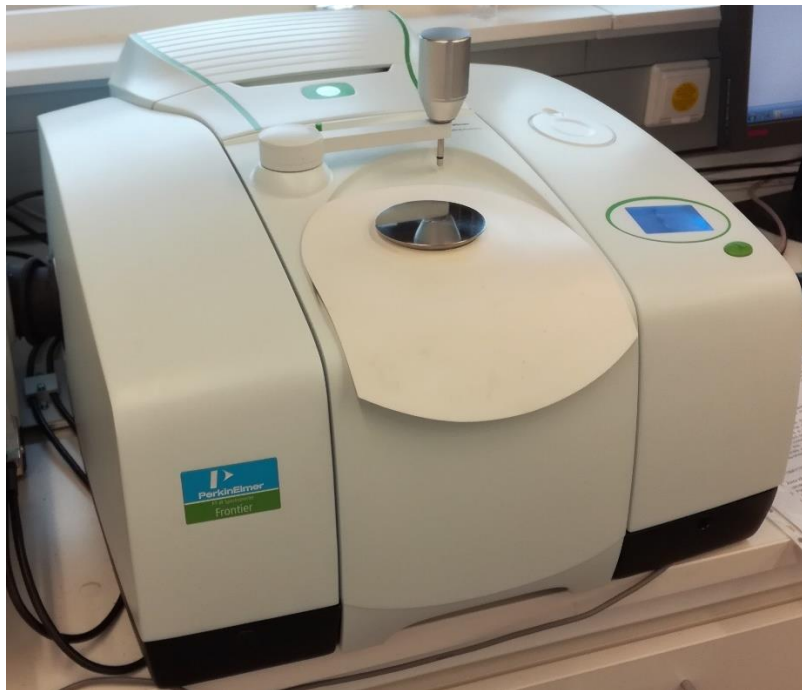
Kuva 7 Näytteiden analysoinnissa käytetty PerkinElmer Frontier FT-IR Spectrometer, jossa on kiinnitetty UATR-lisälaite.
