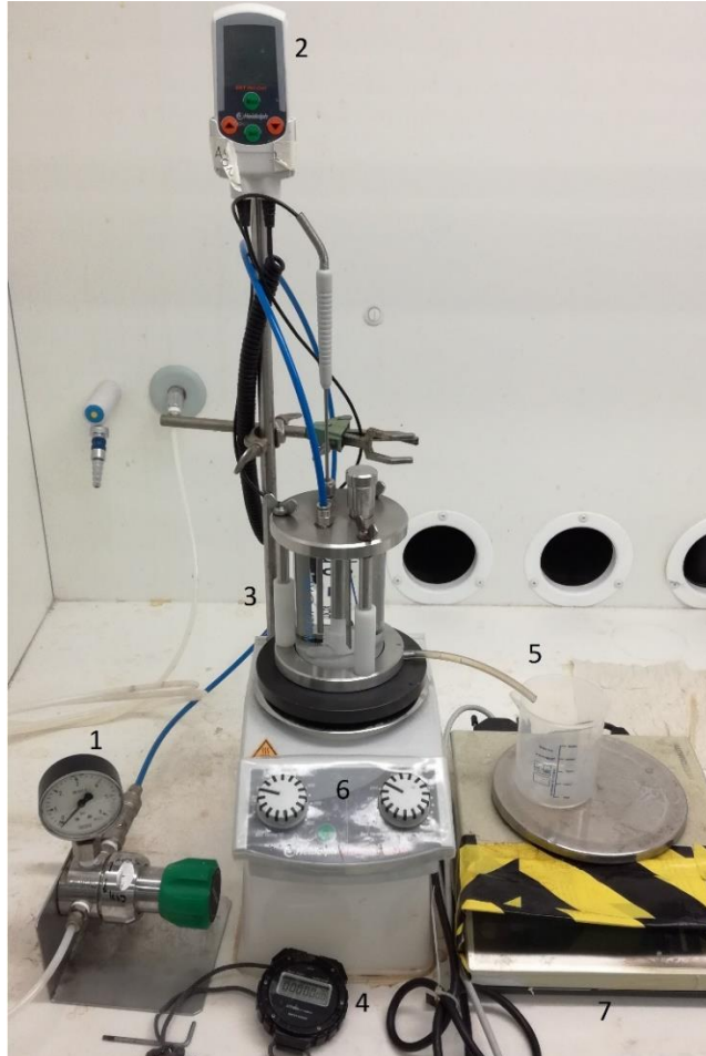
Kuva 5 Membraanin paineistuksessa, puhdasvesivuon mittaamisessa ja hapetuksessa käytetty laitteisto. 1 paineensäätö, 2 lämpötilamittari, 3 Amicon-kenno, 4 sekuntikello, 5 permeaatinkeräysastia, 6 sekoituksen- ja lämpötilansäätö, 7 vaaka.
