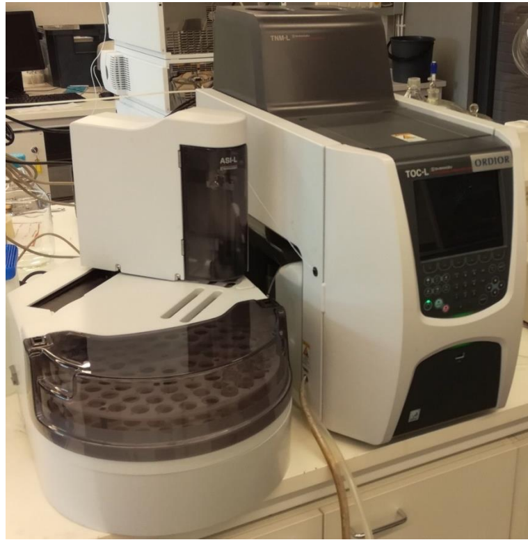
Kuva 8 Membraanin retention mittauksessa käytetty Shimadzu TOC-L, jossa kiinni TNM-L-lisälaite, sekä ASI-L-autosampler.
