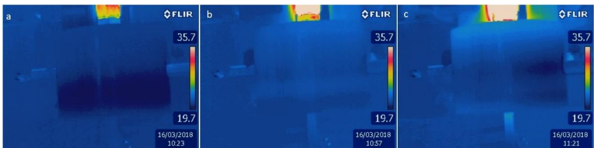
Kuva 19 Lämpökamerakuvat kokeista ajanhetkellä 1 min. Käytetyt ultraäänen tehot olivat 10 % (a), 30 % (b) ja 50 % (c).
