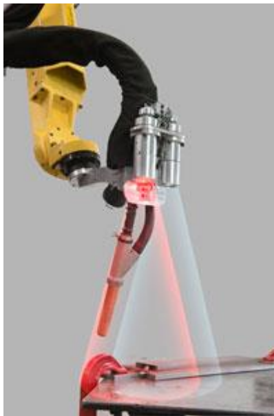
Kuva 2. Fanuc iRVision 3D-lasernäkölaite (Lincoln Electric, 2018).
