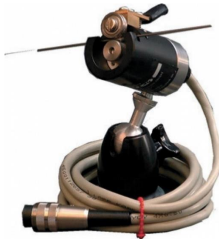
Kuva 5. Retco Oy WeldScanner S3:n langansyöttönopeuden mittausanturi (Retco Oy, 2018).
