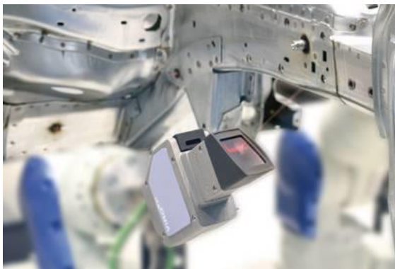
Kuva 1. Vitronic VIRO WSI kamera hitsaussaumojen laaduntarkistukseen (Vitronic, 2018).
