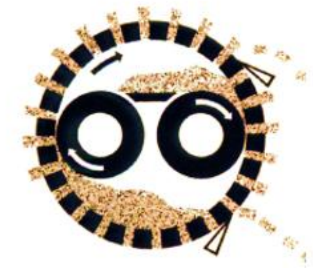
Kuva 12. Pelletöinnin toimintaperiaate. (CPM Europe, 2009)
