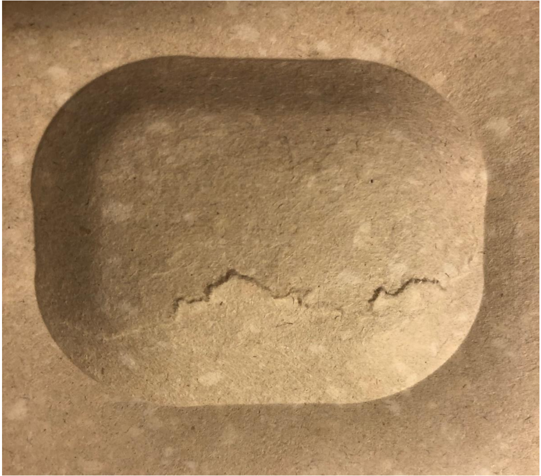
Kuva 28. Rikkoutunut arkki (koepiste 4) syvyyden ollessa 6 mm.
