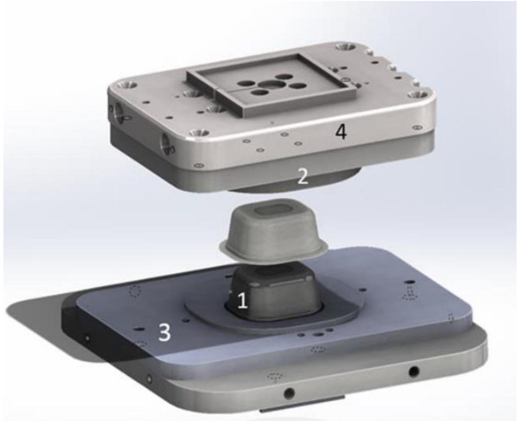
Kuva 8. MiniMould-laitteiston rakenne, jossa 1. urosmuotti, 2. naarasmuotti, 3. kehätyökalu ja 4. lämmitysyksikkö (Tanninen ym. 2017).
