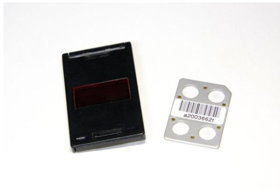
Kuva 3. TL-dosimetrin kuoret ja sen sisällä olevat kiteet (Slovak Legal Metrology)
