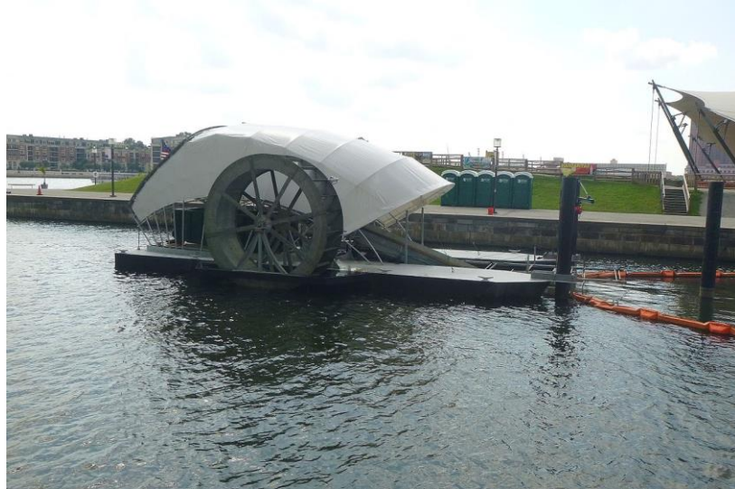
Kuva 4. Mr. Trash Wheel-laitteisto. Aurinkokennot on asennettu laitteiston päälle, taaksepäin kaartuvaan osaan. [30]
