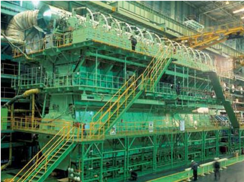
Kuva 11 Emma Maerskin moottori, Wärtsilä RTA96-A, on maailman suurin polttomoottori. Moottorin mittasuhteet erottuvat työntekijöiden avulla. (Emma-Maersk, 2018)
