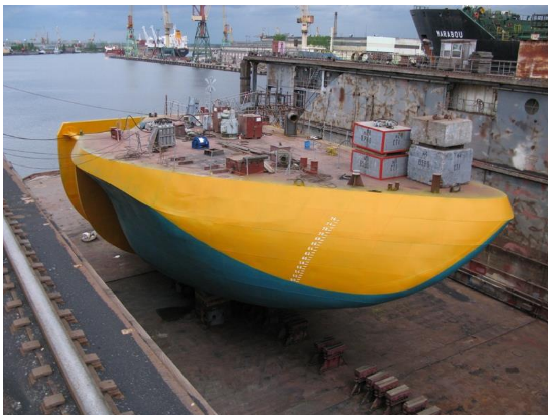
Kuva 8. Wellon kehittämä aaltovoimala, joka hyödyntää aluksen keinuntaa sähkön tuottoon. (Wello 2017)
