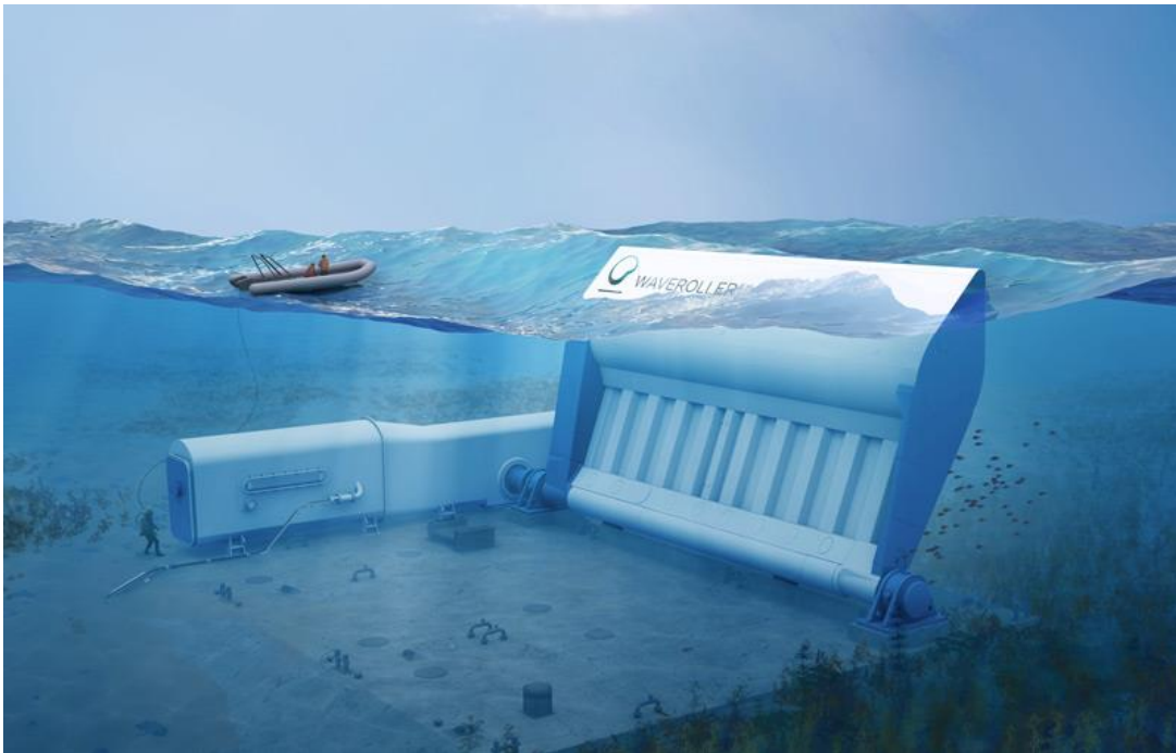
Kuva 9. AW-energyn kehittämä meren pohjaan asennettava aaltovoimala. (AW-energy 2018)
