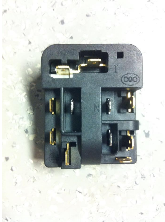
Kuva 2.2 Arkkupakastimen kompressorin kytkentäpinnit. Ylhäällä olevaan I-osioon liitetään vaihejohdin, oikealla olevaan N-osioon nollajohdin ja suojajohdin vasemmalla olevaan maadoitusosioon.
