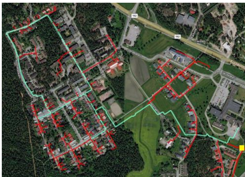
Kuva 33 Petäsmäen kaukolämpöverkko, johon syöttöpiste on merkitty keltaisella
