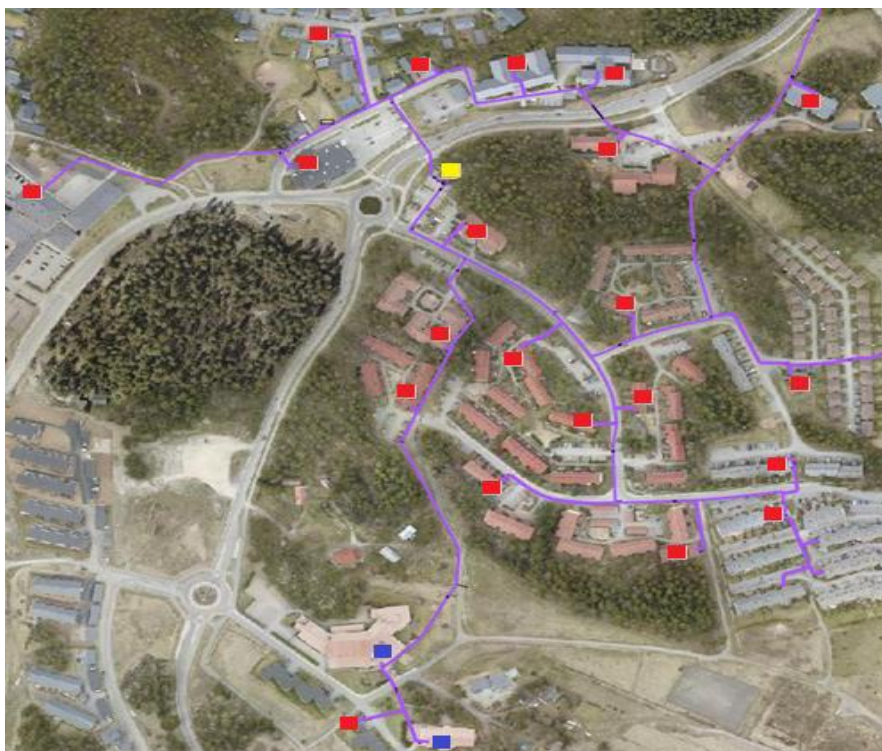
Kuva 23 Myötäisten rengasverkko, asiakkaat on merkitty punaisella neliöllä, kierrolliset asiakkaat sinisellä ja lämpökeskus keltaisella
