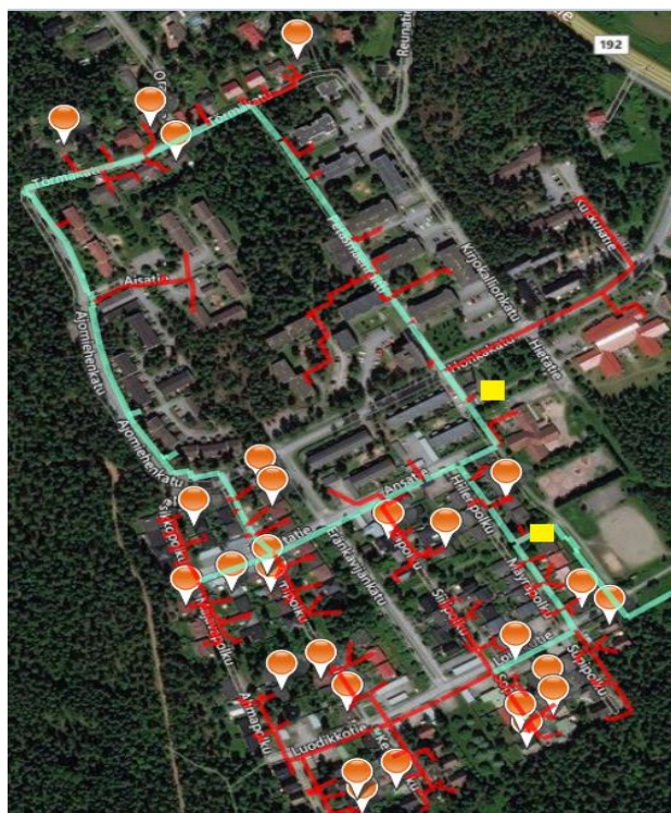
Kuva 35 Petäsmäen asuinalueen haasteellisimmat asiakkaat. Lisäksi kuvaan on merkitty keltaisilla neliöillä lämpöpumpun mahdolliset sijoituspaikat
