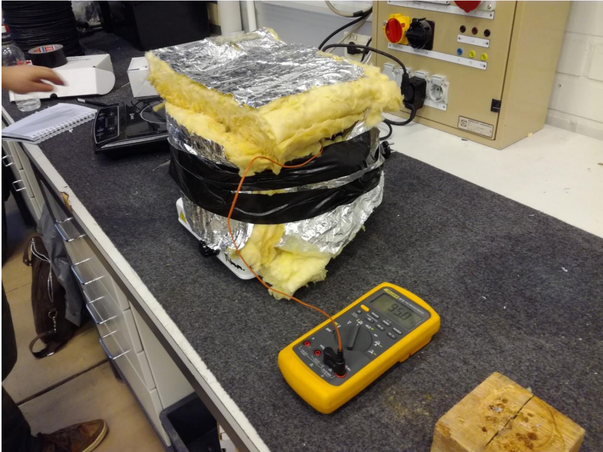
Kuva 3.2 Villalla eristetty kattila
