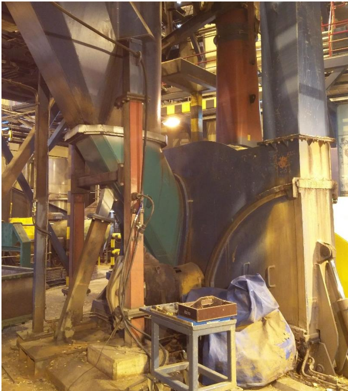
Kuva 12: Kuorimon koivuhakku. Oikealla nähdään hakkeen puhallusputki, vasemmalla hakun syöttösuiste.
