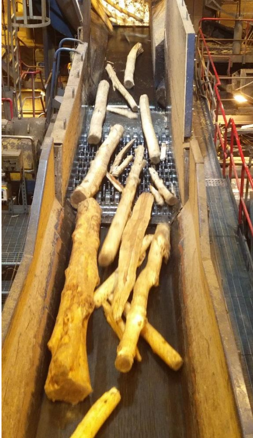
Kuva 23: Puuvirtaa koivuhakulle ennen vastaterän vaihtoa.
