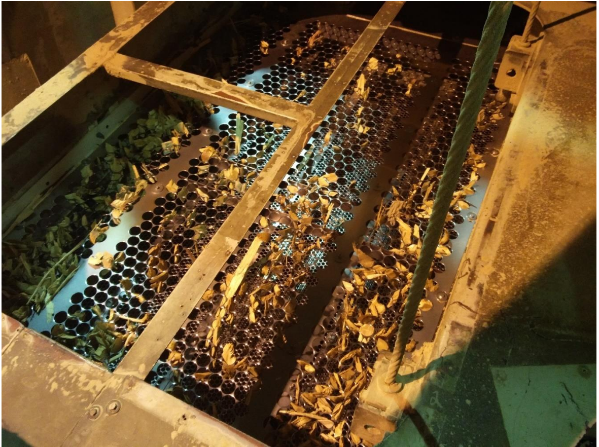
Kuva 16: Koivulinjan tasoseula, kuvassa näkyy noin puolet tasoseulan pinta-alasta. Ylimmälle reikälevylle on kerääntynyt ylisuuria hakepaloja pääosin oksakohdista.
