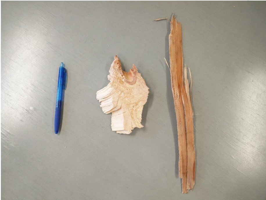
Kuva 20: Havuhakkeen joukossa esiintyneet ylisuuri hakepala ja ohut suikale pintapuuta.
