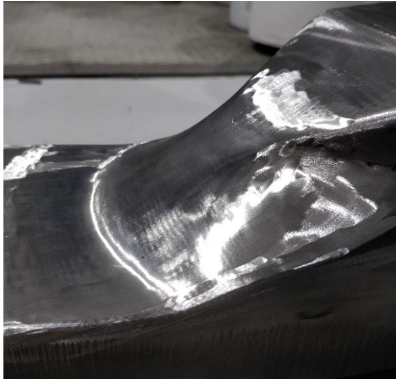
Kuva 13. Pituussuuntaisesti hiottu hitsi.
