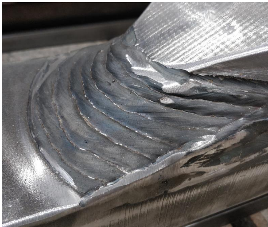
Kuva 11. Hitsatussa tilassa oleva liitos.
