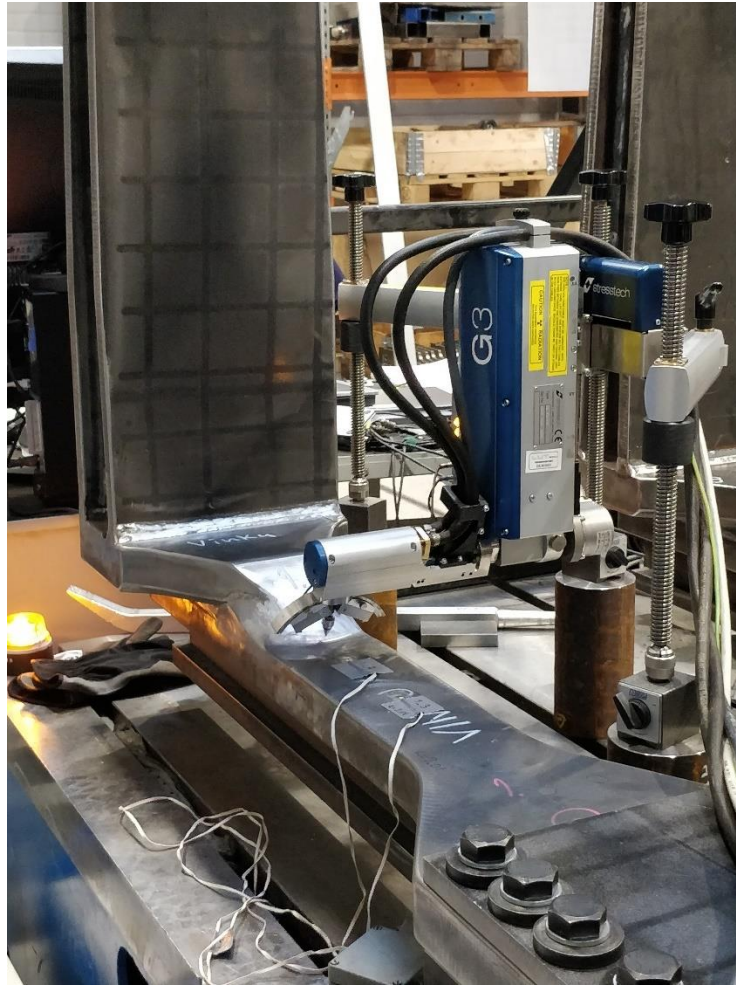
Kuva 28. Jännösjännityksen mittaus pitkittäin hiotun kappaleen rajaviivalta.
