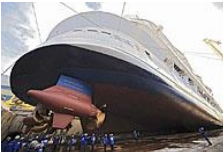
Kuva 10. Oasis of the Seas ja Azipod-ruoripotkuri. (ABB 2009.)
