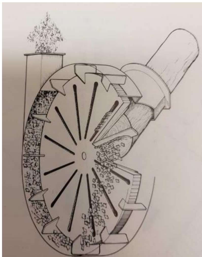
Kuva 4 Puhallustyhjenteisen pystysyöttöisen kiekkohakun toimintaperiaate. (Niiranen, 1983)
