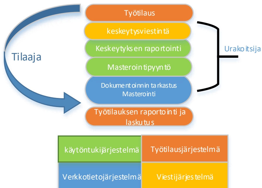
Kuva 3.9 Carunalla nykyisin käytössä oleva pienjänniteverkon kytkentäprosessi. Prosessin eri vaiheissa käytetään useaa eri järjestelmää.
