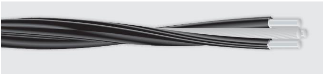
Kuva 2.2 AMKA-riippukierrehjojo. Kolme päällystettyä vaihejohtinta kiertää kannatinköytenä toimivaa nollajohtoa. (Prysmian,2018)
