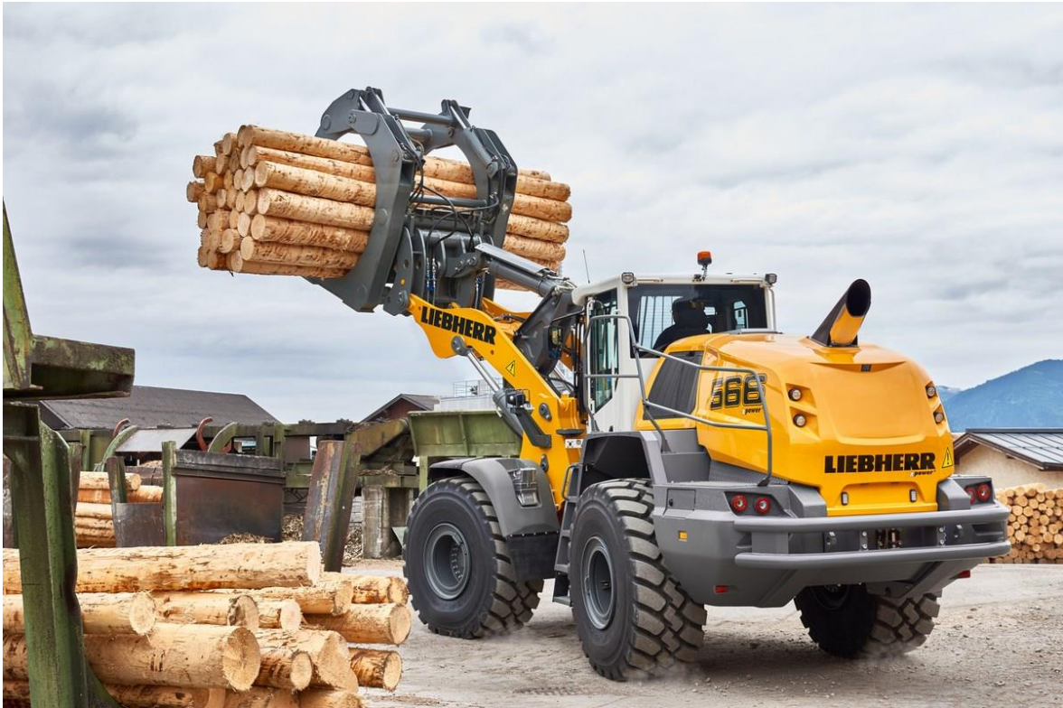
Kuva 1.2 Liebherr L566 -pyöräkuormaaja. Pyöräkuormaaja on etenkin rakennustyömailla hyödyllinen työkonetta, joka hyödyntää tehokkaita mobiilihydrauliikkalaitteita mm. kuorman nostamiseen, vaakasuunnassa kääntyvään runkoon ja ohjaustehostimeen. Kouran tilalle voidaan myös asentaa esimerkiksi kauha tai haarukka, jolloin sitä voidaan soveltaa muihinkin töihin (LECTURA Specs).
