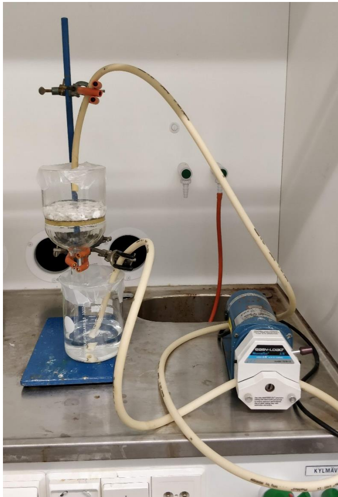
Kuva 4. Koelaitteisto jatkuvatoimiselle kiintopetiadsorptiolle. Koelaitteisto koostuu pumpusta, letkusta, lasisintteristä sekä 1 L dekanterilasista. Pumpun kierroslukua voitiin säätää sen omalla säätimellä.
