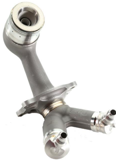
Kuva 5. Morris Technologiesin valmistama polttoainejärjestelmän ruiskutussuutin (GE 2017)
