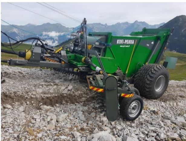
Kuva 2. Kivi-Pekka kivenkeräyskone (Kivenkeräyskone 2019).
