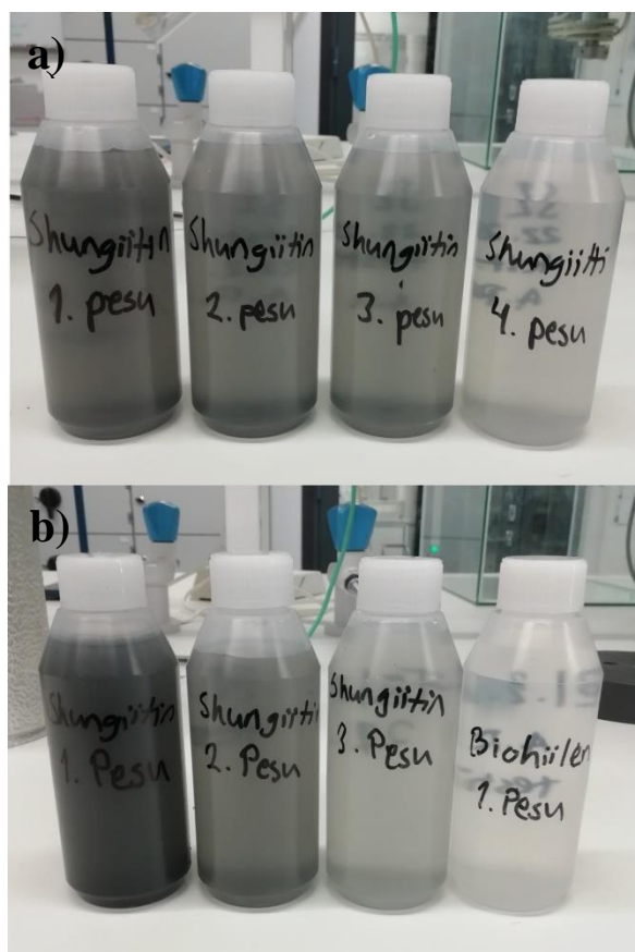
Kuva 10 (a) Irtoavan kiintoaineen määrän määrittäminen toisella shungiiitilla, jossa on suurin hiilipitoisuus eli 48 % hiiltä. Jokainen pesu kesti 15 minuuttia, minkä jälkeen vesi vaihdettiin puhtaaseen. (b) Irtoavan kiintoaineen määrän määrittäminen tyypin 3 shungiiitilla ja biohiilellä. Puhdistettua vettä kierrätettiin shungiiitin tai biohiilen läpi 15 minuuttia kerrallaan, minkä jälkeen vesi vaihdettiin puhtaaseen.
