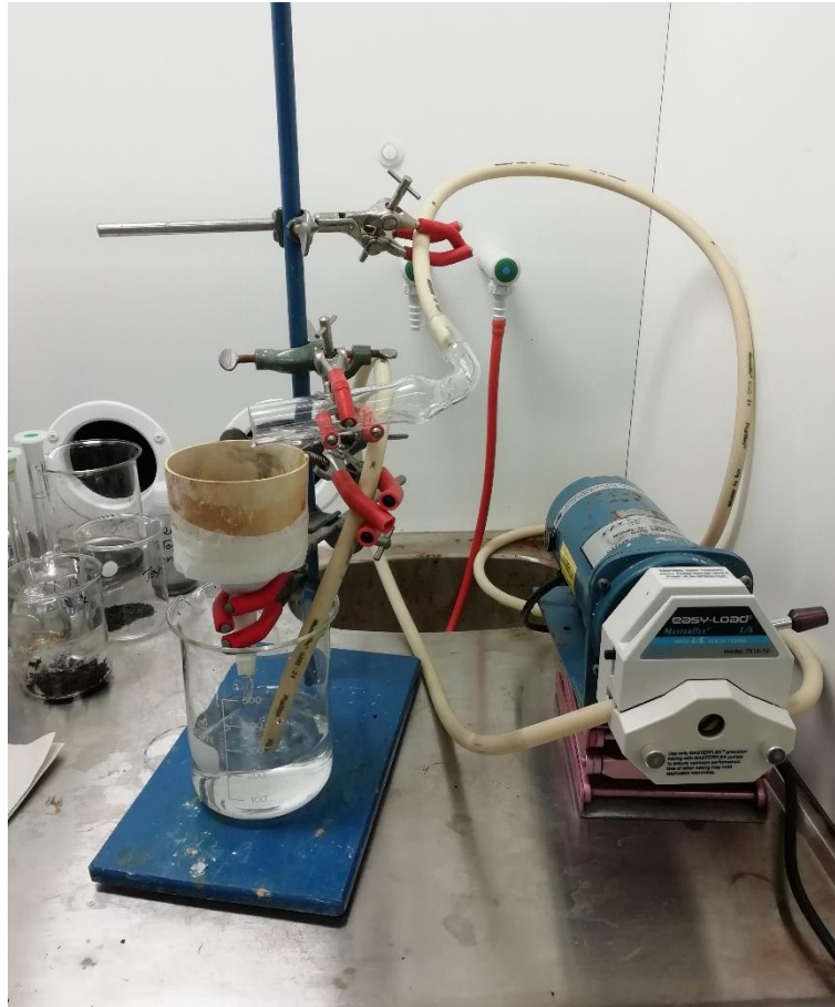
Kuva 7 Koelaitteisto. Laitteisto koostui suuresta dekanterilasista, pumpusta ja letkusta, lisäosasta ja suodattimesta. Suodatin rakennettiin büchnersuppilosta ja suodatinverkosta.
