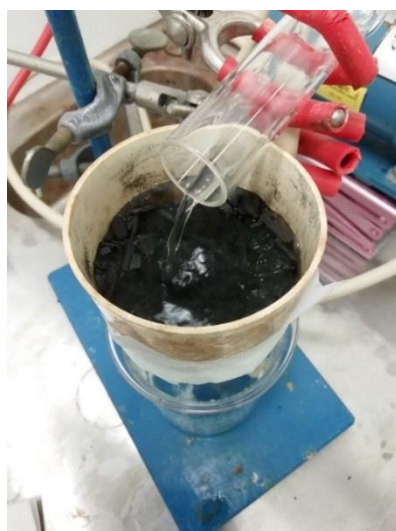
Kuva 9 Suodatuskoe biohiilellä. Vesi kertyy suppiloon ja osa biohiilen palasista kelluu veden päällä.
